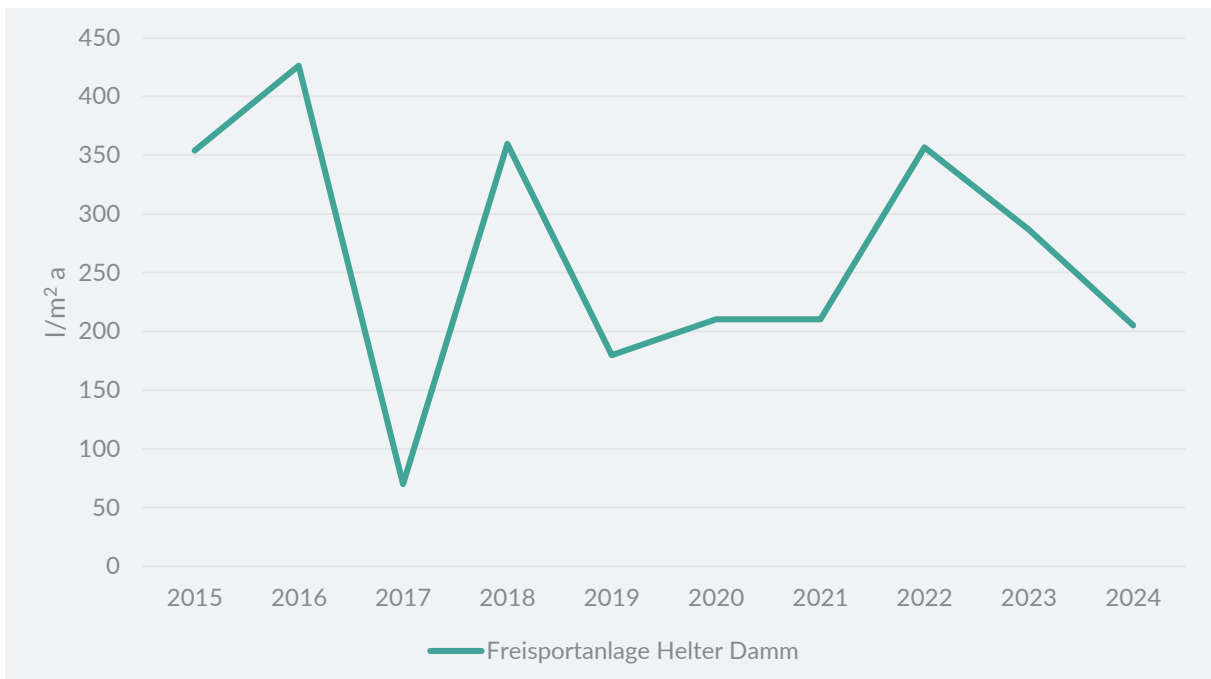
Abbildung 3-29: Entwicklung der spezifischen Wasserverbräuche – Sportplatzgebäude
